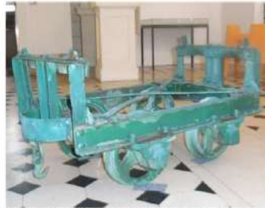
Récupéré et conservé par M. Dauphin, ce châssis d'un wagonnet de déblaiement est actuellement exposé au Musée.
